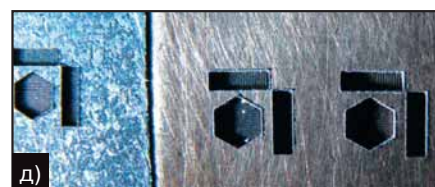
Рис.3. Глубокая фрезеровка: а) дюралюминий-медь, б) керамика, в) ситалл, г) латунь, д) нержавеющая-латунь.
