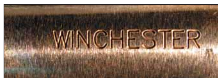
Рис 2. Глубокая фрезеровка, оружейная сталь
